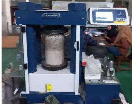
**Gambar 2.3** Alat Uji Kuat Tekan Beton
