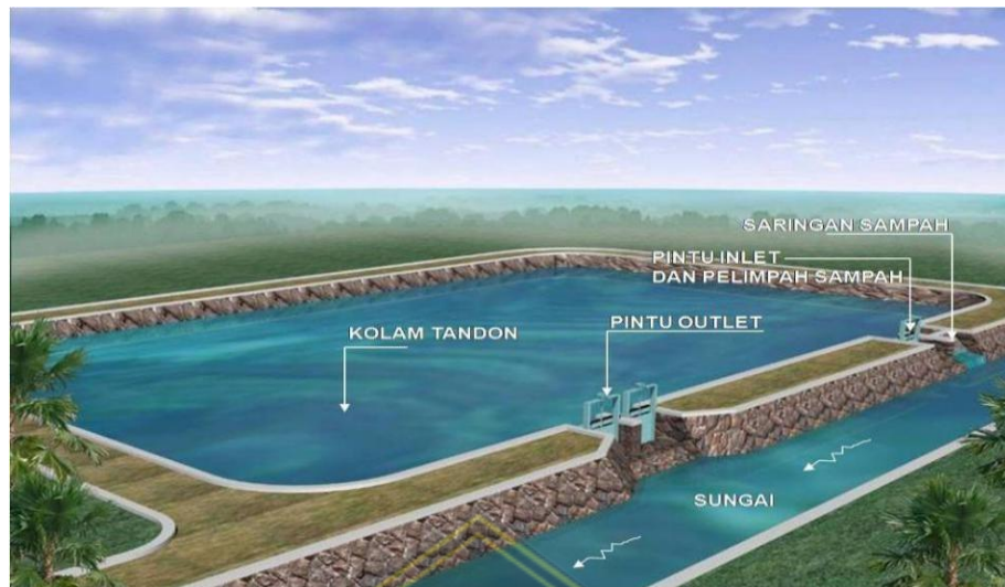
Gambar 2.4. Jenis Kolam Retensi Berada di Samping Badan Sungai
