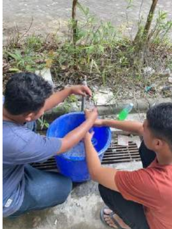
Gambar 3.16 Proses Pencampuran Air Foam Agent Dan Aditif
