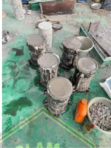
Gambar 3.19 Proses Pencetakan Benda Uji
