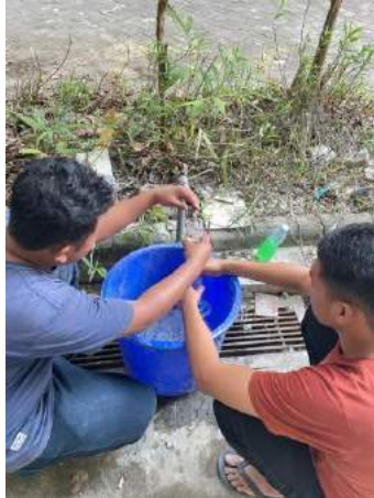
Gambar 3.16 Proses Pencampuran Air Foam Agent Dan Aditif
