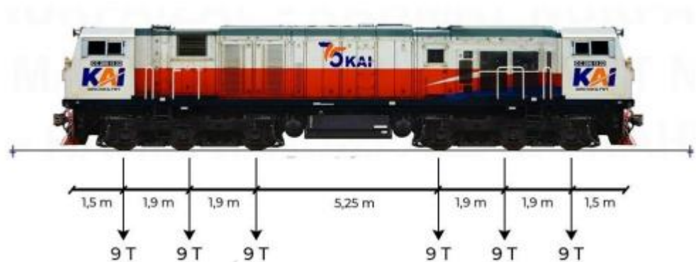
Gambar 4.2 Pembebanan pada Kereta
