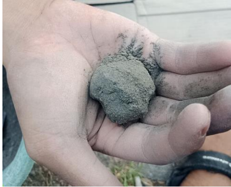
Gambar 4.1. Pengempalan Adukan Dengan Kadar Air 100 ml (Sumber : Data Primer, 2023)
