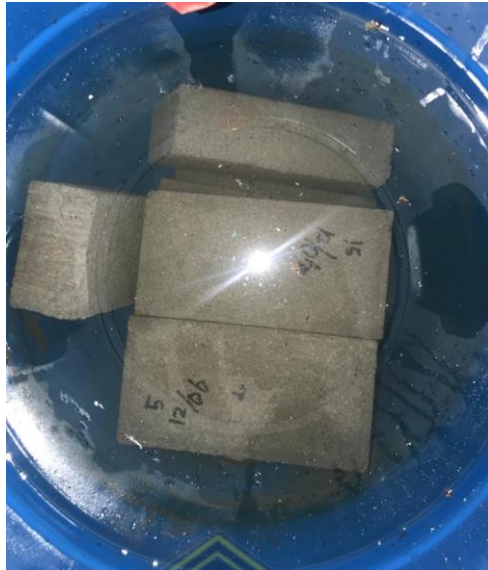
Gambar 3.23. Perendaman Benda uji
