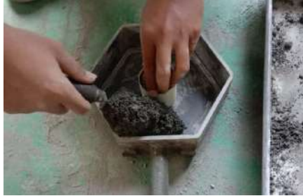
Gambar 3. 19 Pencetakan Paving Block
