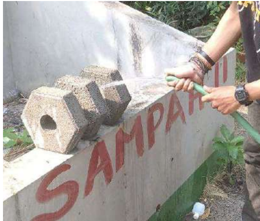
Gambar 3. 21 Perawatan Benda Uji (Sumber: Dokumentasi Pribadi)
