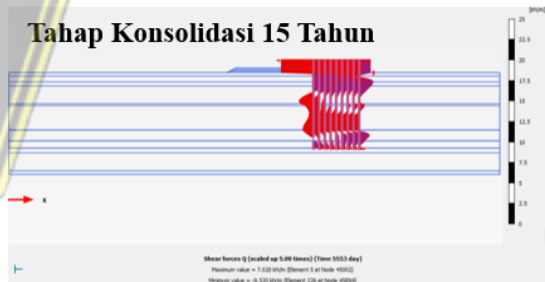
Gambar 4. 50 Shear Forces (Q) dengan Tanah Timbunan Jarak (x) = 10 m ; Tinggi (y) = 3 m
