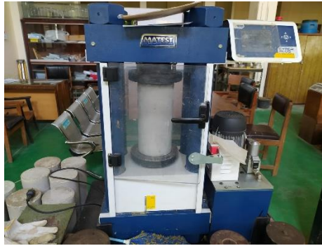
Gambar 4.8 Pengujian Kuat Tekan Benda Uji Silinder Umur 28 Hari
