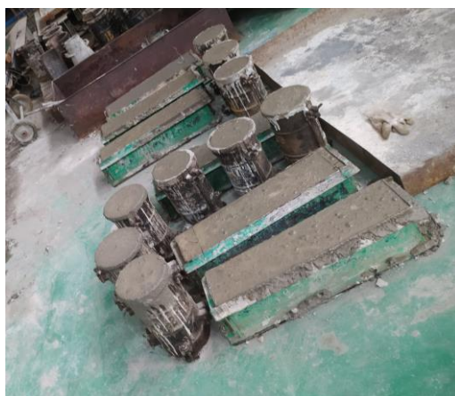
Gambar 4.5 Beton Segar Dalam Bekesting
