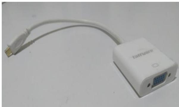
Gambar 4. 5 Converter HDMI ke VGA
