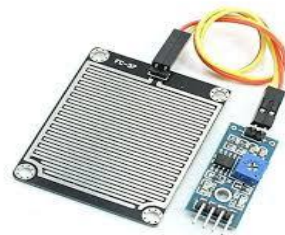
Gambar 2.6 Sensor air hujan
