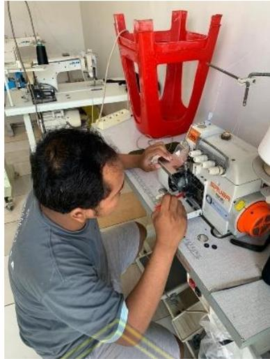
**Gambar 4. 14** Pembersihan mesin jahit setelah proses produksi
