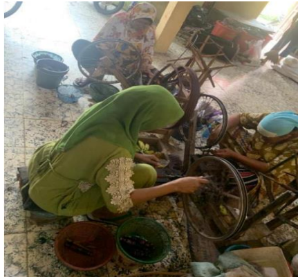
Gambar 4.9 Proses Penggulungan menggunakan Roda Sepeda
