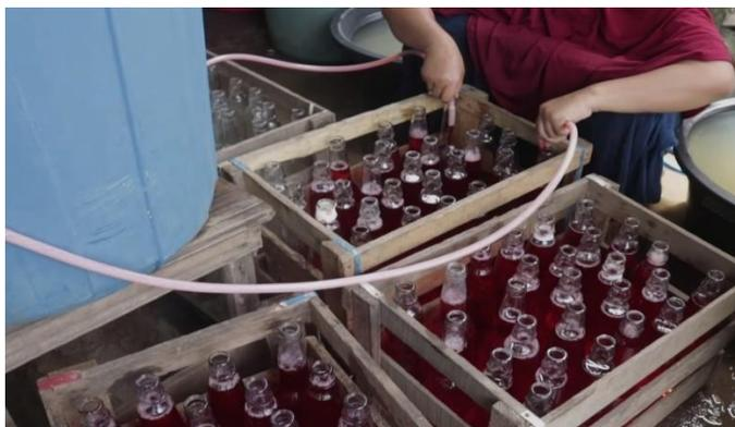
**Gambar 4.4** Proses memasukan bahan baku limun kedalam botol
