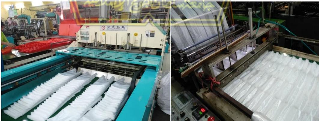
**Gambar 4.8** Proses pemotongan kemasan plastik
