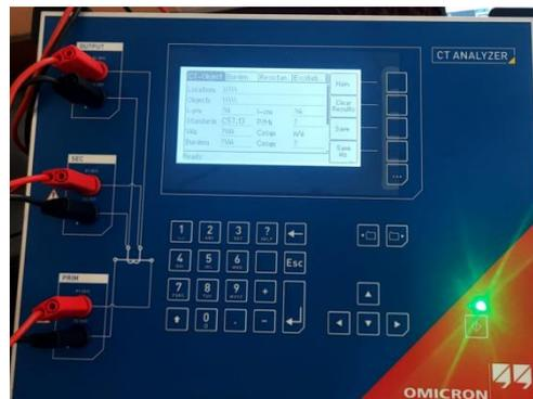
Gambar 3. 10 Pengujian dengan CT analyzer
