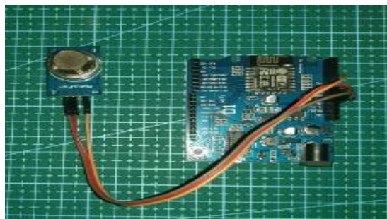
Gambar 3. 8 Konfigurasi Pin Sensor MQ 135 ke ESP8266
