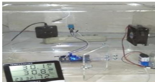
Gambar 4. 13 Pengujian Sensor DHT 11 Dengan Alat Ukur Standar Kelembapan Terbaca 72 %
