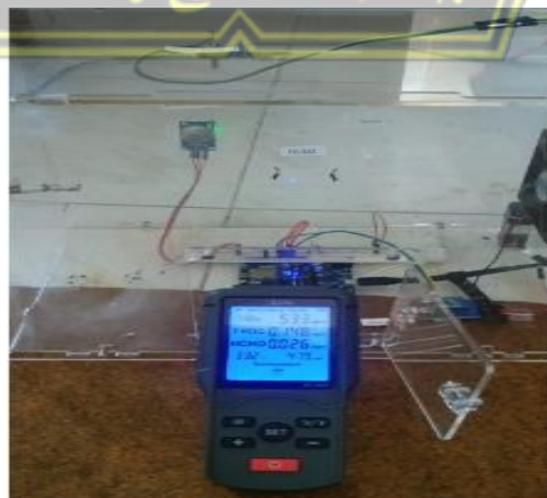
Gambar 4. 8 Pengujian Sensor MQ 135 Dengan Alat Ukur Standar Udara Kotor >500
