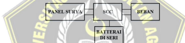
**Gambar 3. 4 Diagram Blok PLTS (Pembangkit Listrik Tenaga Surya)**
