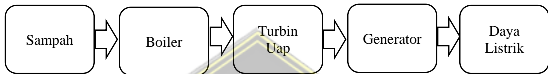
Gambar 4.1. Blok diagram alur konversi energi
