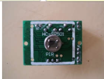
Gambar 2.8a Bentuk fisik sensor PIR KC 778b tanpa lensa fresnel
