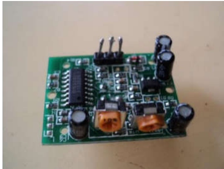
Gambar 2.10 Bentuk Fisik Pengontrol Sensor PIR (HC SR501)
