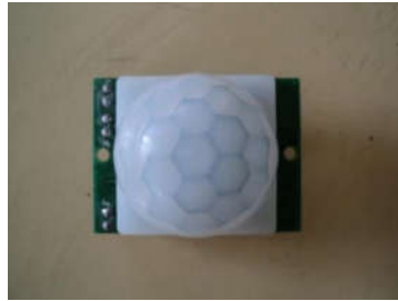
Gambar 2.8b Bentuk fisik sensor PIR KC 778b dengan lensa fresnel
