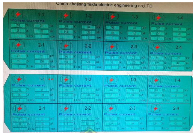
Gambar 4.4 Proses Rapping pada Monitor DCS ESP
