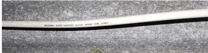
**Gambar 2. 10** Kabel Penghantar Instalasi Listrik Tipe NYM
