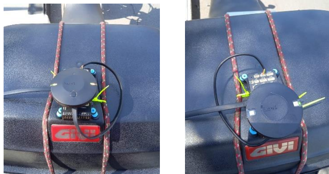
Gambar 3. 7 Instalasi Pixhawk dengan GPS
