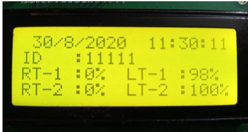
**Gambar 4.3.** Pengujian rangkaian LCD
