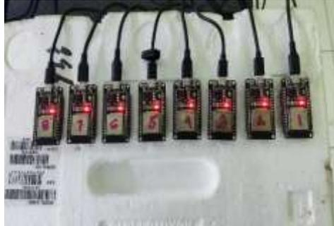
**Gambar 4.1** NodeMCU terhubung dengan *Power Supply*
