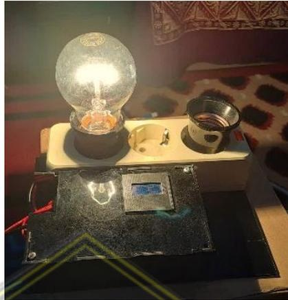
Gambar 4.2. Pengujian prototipe dengan beban resistif lampu pijar 5 Watt.
