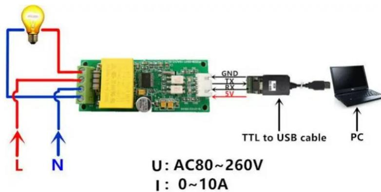
Gambar 3.6 Diagram pengkabelan PZM004 [29]
