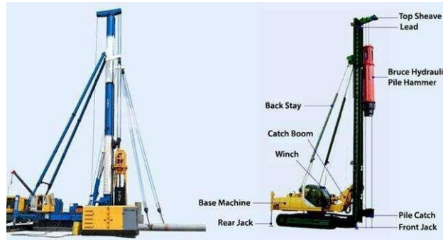
Gambar 2.8 Alat Pemancang Tiang
