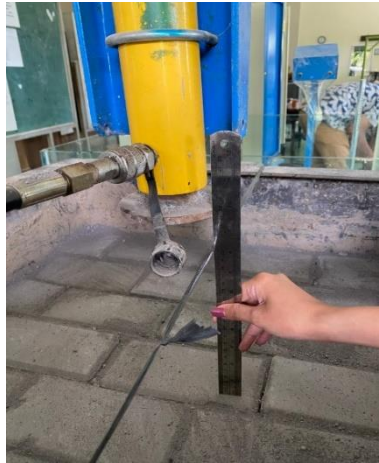
Gambar 3.21. Menghitung Ketinggian Awal Paving
