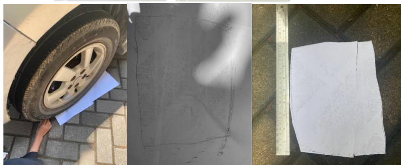
Gambar 3.24. Pengukuran untuk mencari luasan bidang ban mobil yang berada di atas paving block pada keadaan riil.
