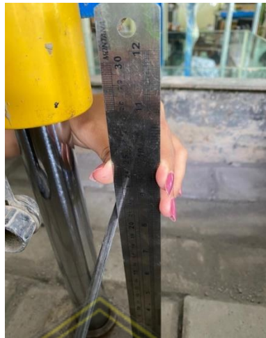
Gambar 3.23. Pengukuran setelah dilakukan uji pembebanan vertikal
