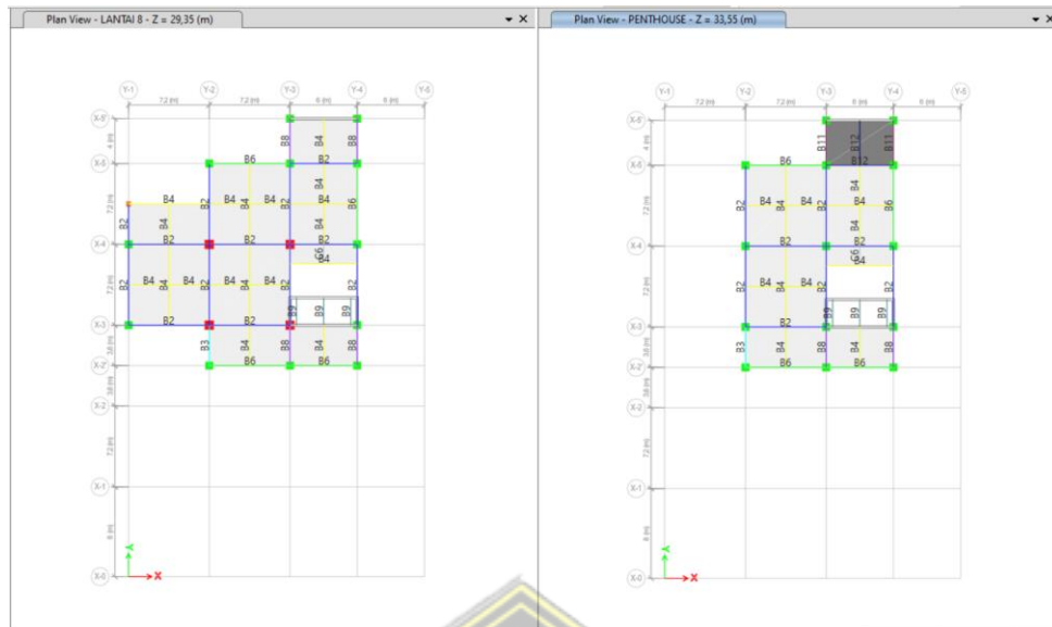
Gambar 4.15 Denah Balok Lantai 8 dan Lantai Penthouse
