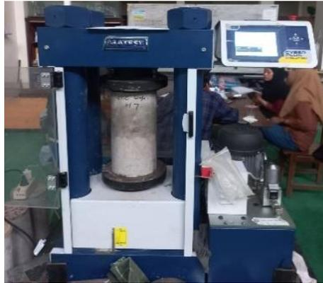
**Gambar 2. 3.** Alat Uji Kuat Tekan Beton
