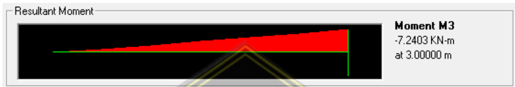
Gambar 4.31. Besar M_{MAX} Lengan Atas pada SAP 2000
