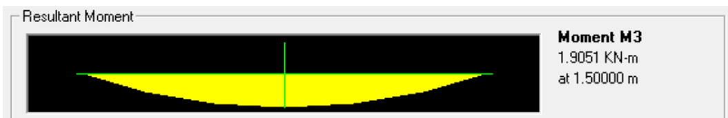
Gambar 4.13. Momen Maksimum Gelagar Memanjang pada SAP 2000
