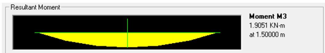
Gambar 4.13. Momen Maksimum Gelagar Memanjang pada SAP 2000
