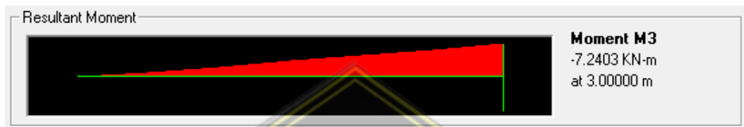
Gambar 4.31. Besar M_{MAX} Lengan Atas pada SAP 2000
