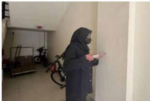
Gambar 3.6. Pengujian Kekerasan dengan Alat Schmidt Hammer
