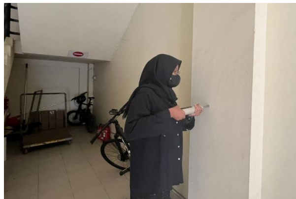
Gambar 3.6. Pengujian Kekerasan dengan Alat Schmidt Hammer
