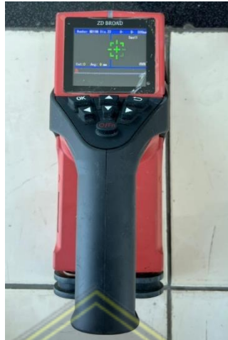
Gambar 3.8. Alat Uji Rebar Detector
