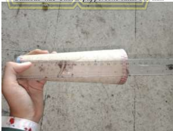
Gambar 4.24 Ukuran pappercone benar 172 mm
