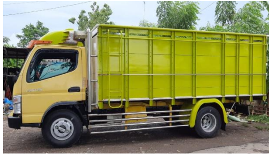
Gambar 4. 14 Bak Papan Kayu Truk double
