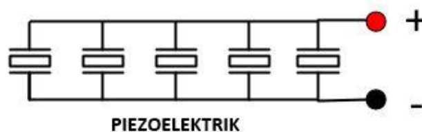
Gambar 3. 5 Rangkaian Paralel Piezoelektrik
