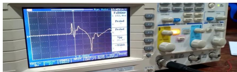
Gambar 4. 15 Gelombang hasil pengujian prototipe papan biasa rangkaian paralel menggunakan berat 10 kg.
