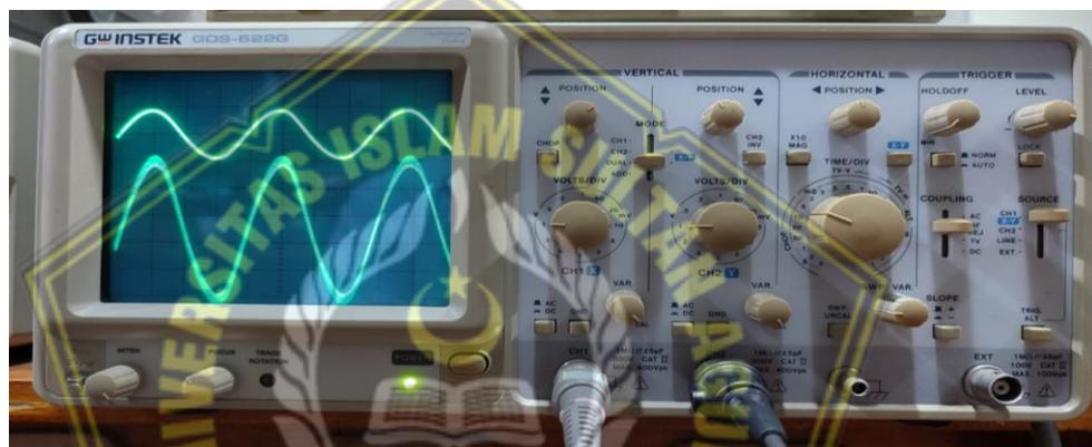
**Gambar 4. 6** Bentuk Gelombang Pada Output Inverter
