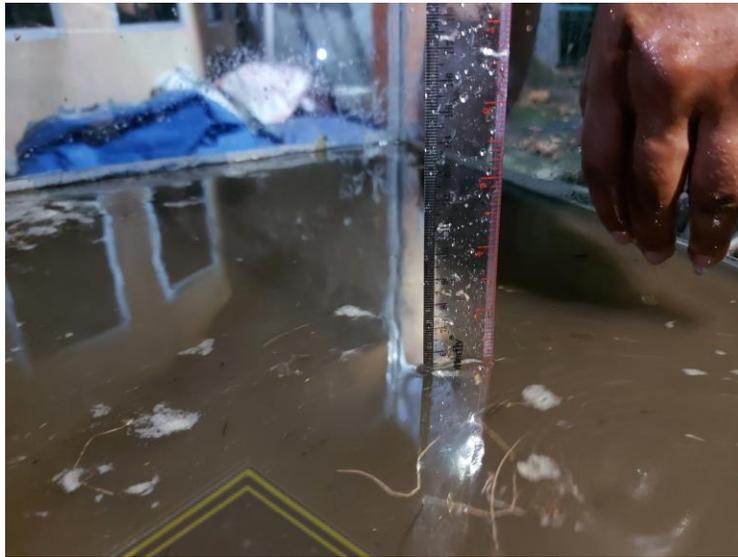
**Gambar 4.4.** Pengukuran kedalaman area yang terlikuifaksi
