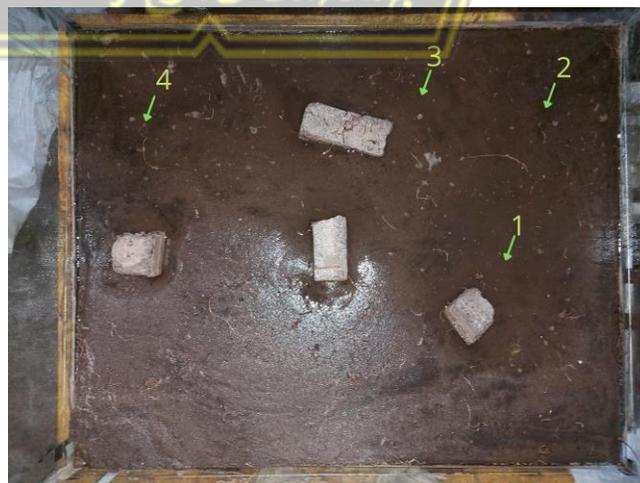
**Gambar 4.5.** Hasil pengukuran kedalaman area yang terlikuifaksi
