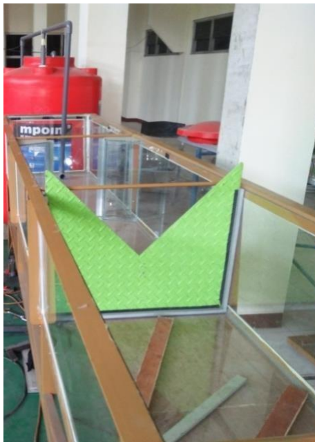
Gambar 4.1: Sirkuit Kanal Tertutup Dilengkapi Kerangka Bak Kaca
