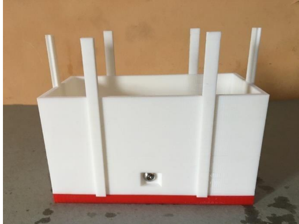
Gambar 3.11: Model Miniatur Bendung Barrier Plastik
