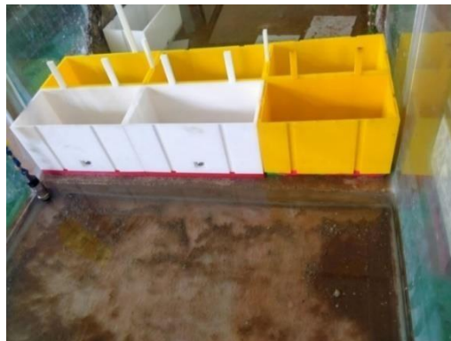
Gambar 4.3: Percobaan Penataan Bendung Pada Sirkuit Kanal Tertutup
