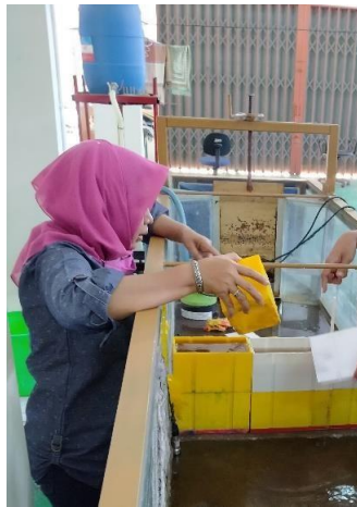
Gambar 4.8: Pengisian Tubuh Bendung Skenario 2
