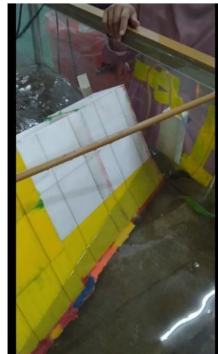
Gambar 4.19: Tubuh Bendung Skenario 4 Roboh
