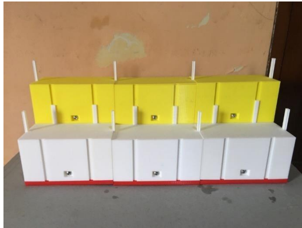
Gambar 3.14: Pemasangan Miniature Bendung Barrier Plastik
