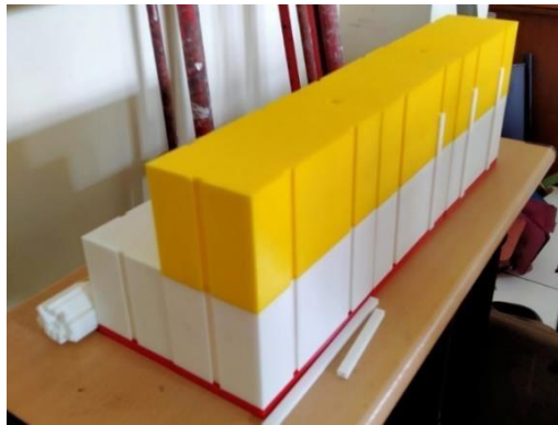
Gambar 4.2: Rangkaian Model Bendung Barrier Bentuk L (9 Unit)
