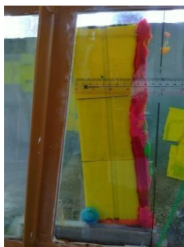
Gambar 4.14: Tubuh Bendung Skenario 3 Mengalami Kemiringan
