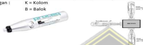
Selanjutnya data diolah berdasarkan perhitungan SNI 03-4430-1997 untuk memperoleh perkiraan nilai beton eksisting. Berikut merupakan contoh tabel pengolahan data Hammer Test yang disajikan pada tabel 3.1 dan form pengujian data Hammer Test pada gambar 3.8 sebagai berikut :
