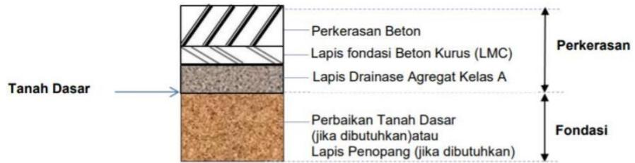
**Gambar 2.8** Tipikal struktur perkerasan kaku pada permukaan tanah asli
