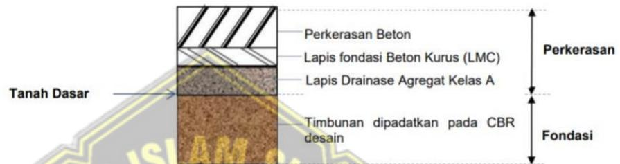
**Gambar 2.9** Tipikal struktur perkerasan kaku pada timbunan
