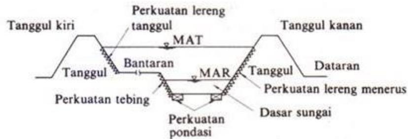
Gambar 2.7 Stabilitas Lereng Konstruksi *Revetment*.
