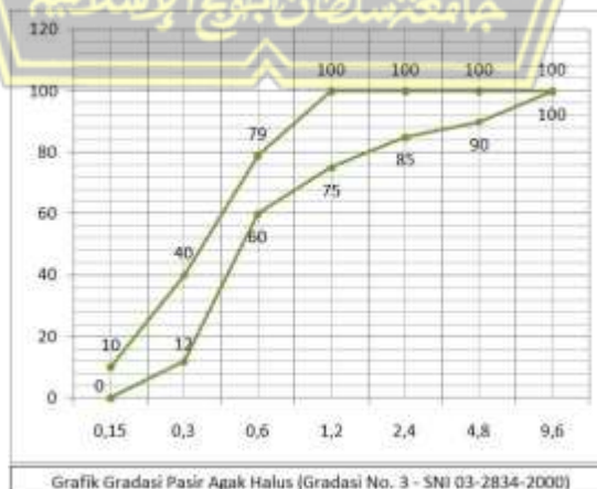
Gambar 2.3 - Grafik Gradasi Pasir Agak Halus (Gradasi No. 3)
