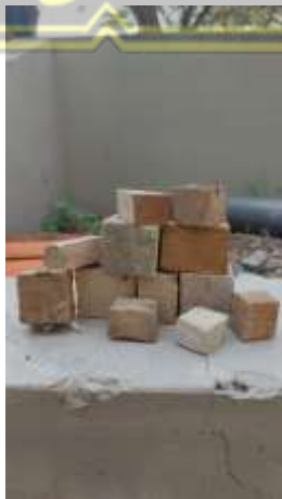
Gambar 3.4 - Agregat Kasar Potongan Kayu
