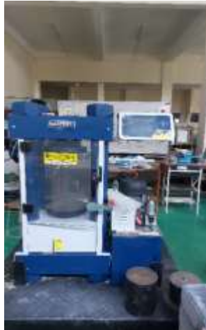
Gambar 3.11 – Mesin Uji Kuat Tekan
