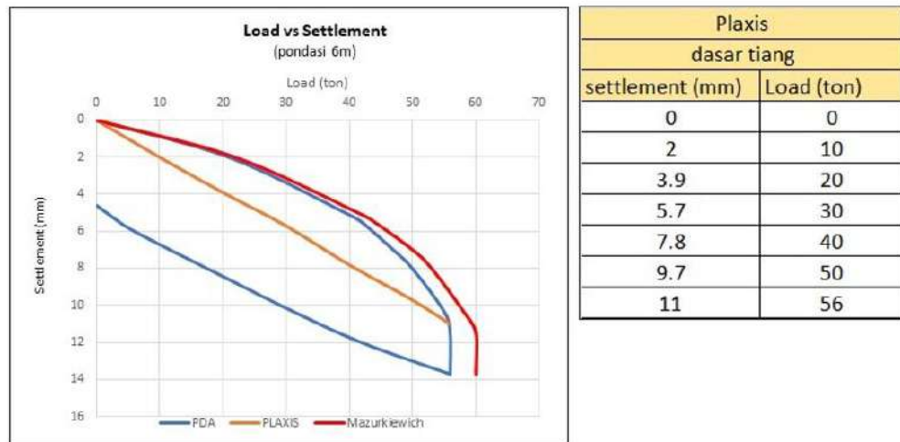
Gambar 4.40 Perbandingan Penurunan di dasar tiang 6 m vs PDA 6B
