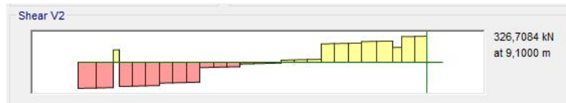
Gambar 4.76. Output gaya geser comb. beban gravitasi tump. kiri
