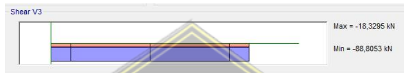
Gambar 4.99. Output gaya geser pada ETABS V18
