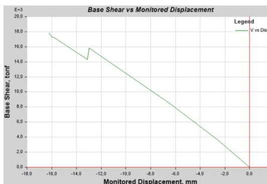
Gambar 4.62. Kurva gaya geser vs displacement struktur ( pushover arah X)
