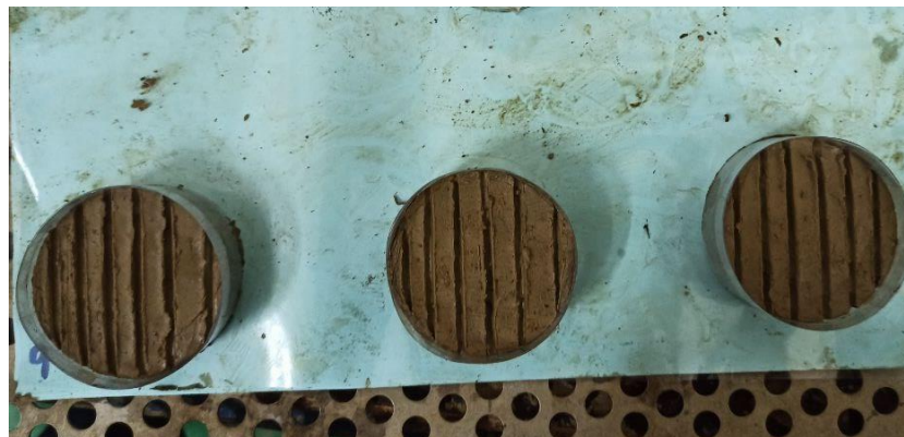
Gambar 4.10 Sampel tanah- beton kekasaran 6
