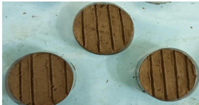
Gambar 4.7 Sampel tanah- beton kekasaran 4
