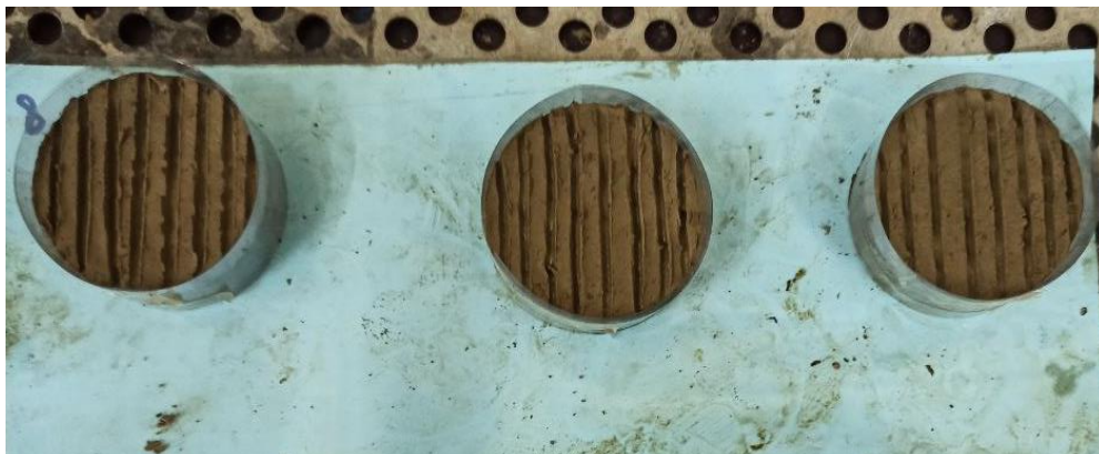
Gambar 4.13 Sampel tanah- beton kekasaran 8
