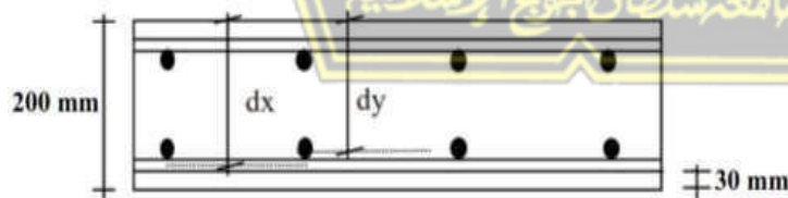
Gambar 4.21 Penulangan Pelat Tumpuan Arah Lajur Tengah
